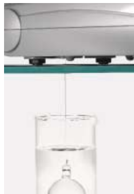
Determinazione della densità pesando da sotto la bilancia
